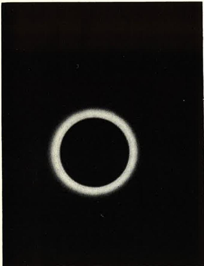
Figure 10. Lumière stationnaire d'E.C.L. à l'électrode disque-anneau.
