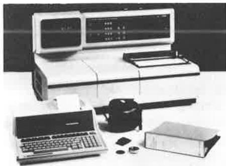
travailler avec le calculateur HP 85, couplé directement avec le PU 8800, via l'interface bidirectionnelle RS 232C.
