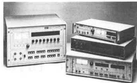
Le pont F 26, qui vient compléter la série F 16, F 17 et F 17 A de la société Automatic systems Laboratories est un pont entièrement automatique piloté par microprocesseur, capable de donner en lecture digitale 7,5 digits, les paramètres températures en ° C, K, ohms ou ratio. Il peut être équipé en option des sorties I.E.E.E. et R.S. 232.
