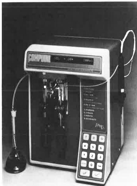
Cassette et seringues sont facilement interchangeables. Le Compu-dil utilisé à pleine capacité nécessite 6 seringues.
