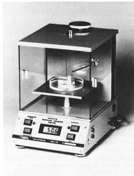
1,999 g/cm<sup>3</sup>, 1 mg à 1 500 mg; précision  $\pm 0,5$  % ( $\pm 1$  chiffre); mesure de température - 10 à 50 °C; zéro automatique; contrôle de calibrage; sélecteur mg/cm<sup>3</sup>-mN/m; sortie pour enregistrement.
