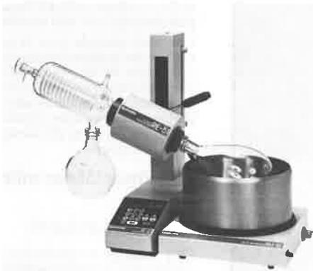
Les contrôles numériques de la vitesse avec régulation par tachymètre entre 15 et 190 t/mn, de la température du bain-marie entre + 5 °C et 99 °C avec affichage de la consigne assurent régularité et précision. La localisation de toutes les commandes sur le même panneau de contrôle, la montée et descente automatiques de la verrerie, ainsi que son inclinaison variable assurent simplicité et confort dans le travail.
