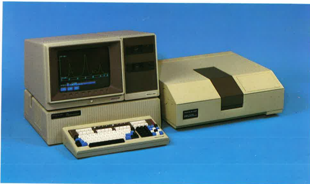
Le Lambda 3840 à barrette de diodes (à droite) avec l'ordinateur de la série 7000 de Perkin-Elmer
