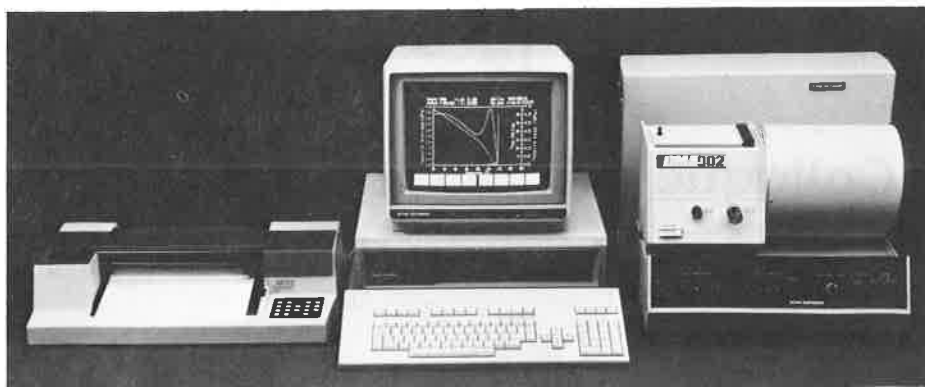
Un système multi-tâches : Le nouvel Analyseur Thermique/Ordinateur 9900 du Du Pont est un système modulaire, conçu pour toutes les techniques thermo-analytiques; notamment la DMA (illustrée sur cette photo), la DSC, l'ATD, l'ATG et l'ATM. Multitâche, il peut réaliser plusieurs opérations simultanément. Multimodule, il peut effectuer en même temps quatre expériences indépendantes, sur des modules identiques ou selon quatre techniques différentes.
