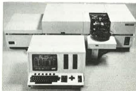
conception du système de pilotage. Les nouveaux instruments utilisent un micro-ordinateur comme seule interface, entre l'opérateur et les différentes parties du système. Cette conception de pilotage centralisé comprend un protocole d'utilisation efficace, l'opérateur se servant de logiciels d'emploi simple spécifiquement adaptés à l'absorption atomique (fill in the form).
