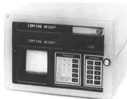
La centrale de commande intègre en permanence la valeur moyenne de l'humidité. L'affichage permet, outre la lecture de l'humidité, le contrôle de tous les paramètres de base ainsi que l'identification des alarmes telles que : perte du produit, seuil d'humidité mini-maxi, température. L'entrée des données peut s'opérer de 3 façons : clavier à touche sensibles, carte programme (BSP 4000 seulement) et ordinateur.
