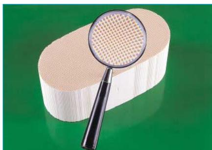
Figure 1 - Monolithe céramique (photo IFP).
