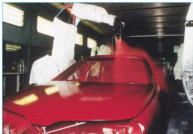
Figure 2 - Application automatique d'une base colorée (Renault, Sandouville).
