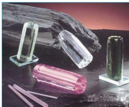
Figure 6 - Cristaux de grenats purs (transparents) et dopés par l'ion néodyme (rose violacé) ou codopés par le chrome et le thulium (vert) tirés par la méthode de Czochralski. On peut observer des barreaux laser cylindriques prêts à être utilisés dans les cavités laser (photo Crimatec-Gières, France).
