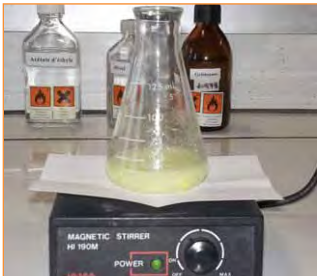
Figure 2 - Milieu réactionnel sous agitation magnétique ; formation du précipité de dibenzalacétone.
