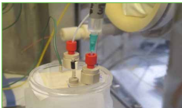
Figure 7 - Couplage entre un microsystème séparatif par isotachophorèse et un ICP-MS pour l'analyse des lanthanides (collaboration CEA Saclay, Direction de l'Énergie Nucléaire, Département de Physico-Chimie et Université de Lyon 1) [36].
