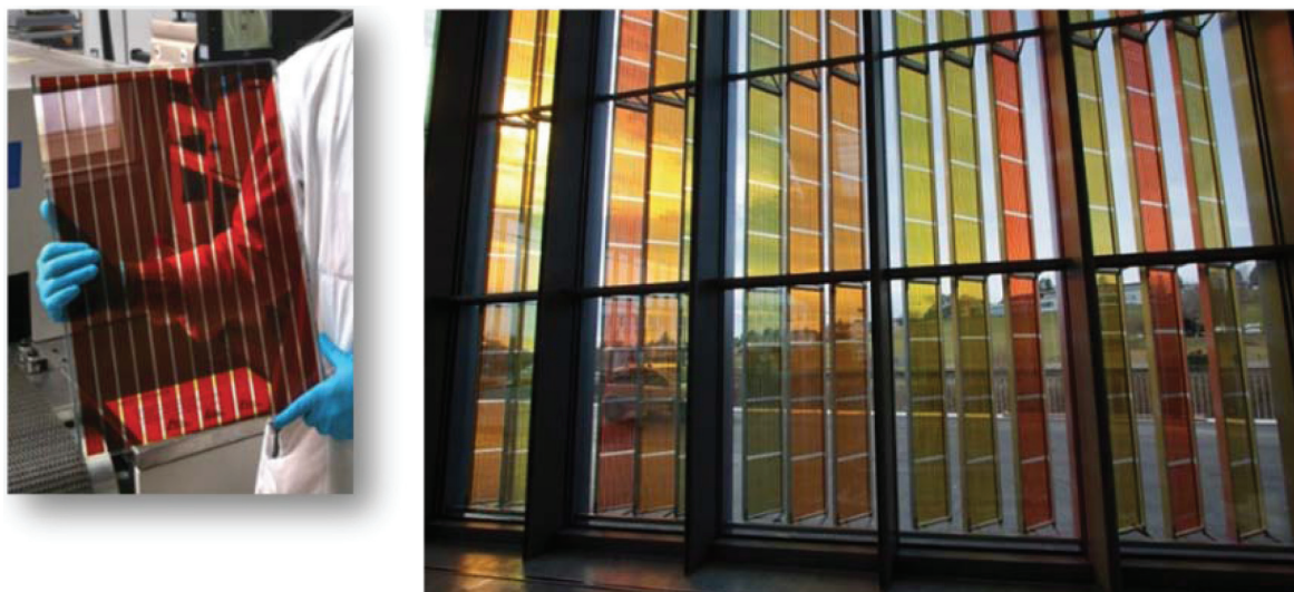
Figure 3 - Module de 1 800 cm 2 fabriqué par la société Solaronix avec RK1 (gauche) et vue intérieure de la façade multicolore photovoltaïque réalisée avec des modules de cellules à colorants et intégrée au Palais des congrès de l'EPFL en Suisse.
