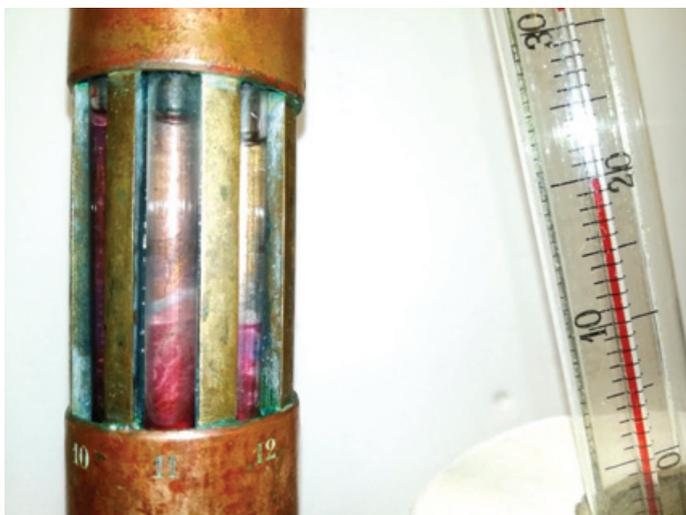
Figure 7 - Observations des tubes scellés du thermomètre à *minima* de Duclaux (gauche) après avoir été immergé dans un liquide à 10 °C puis laissé 1 h à température ambiante dans la pièce à 20 °C. La température de la pièce est mesurée par un thermomètre à capillaire (droite).
