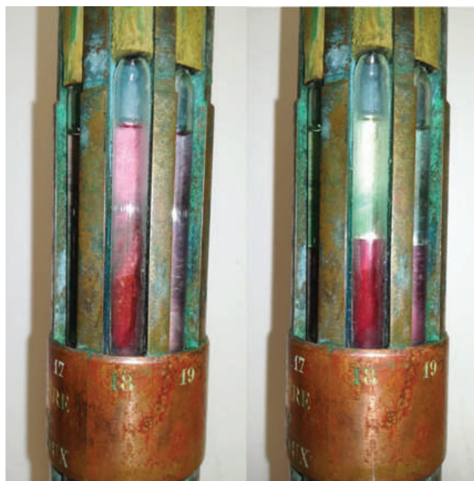
Figure 5 - Photo du même tube scellé (à 18 °C) avant démixtion (gauche) et après démixtion où l'on observe les deux liquides qui ont démixé (droite).
