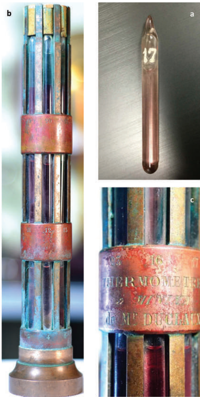
Figure 3 - a) Un des tubes scellés supplémentaires présent dans la boîte en bois. b) Le thermomètre, sans le cylindre en laiton de protection, montrant l'empilement des tubes scellés le long du corps cylindrique en cuivre. c) La plaque avec la mention « THERMOMETRE à MINIMA de M r DUCLAUX ». © Vincent Noclin/Université de Lyon.
