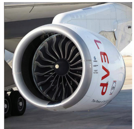
Figure 5 - Aube fan du moteur LEAP A1 (CFM International) réalisée par tissage 3D de fibres de carbone puis injection de résine époxyde en technologie RTM (« resin transfer molding »). Photos Safran, DR.
