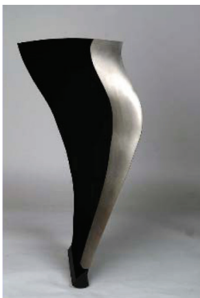
Figure 5 - Aube fan du moteur LEAP A1 (CFM International) réalisée par tissage 3D de fibres de carbone puis injection de résine époxyde en technologie RTM (« resin transfer molding »). Photos Safran, DR.
