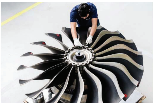
Figure 5 - Aube fan du moteur LEAP A1 (CFM International) réalisée par tissage 3D de fibres de carbone puis injection de résine époxyde en technologie RTM (« resin transfer molding »). Photos Safran, DR.
