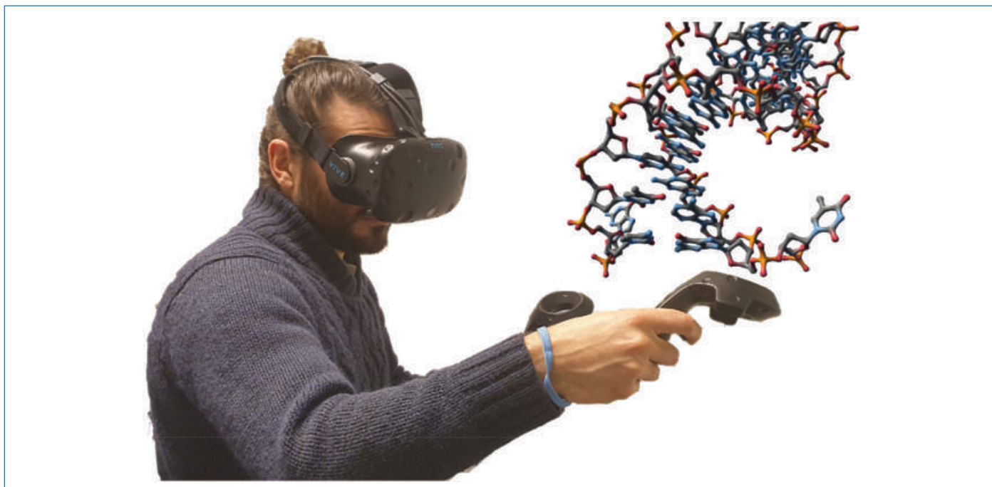
Figure 4 - Manipulation intuitive et naturelle des objets moléculaires animés par des simulations physiques. Ici un simple brin d'ADN, vu en réalité virtuelle et déformé avec les manettes du casque de réalité virtuelle, permettant d'attraper des atomes et d'exercer une force de ressort dans toute direction.
