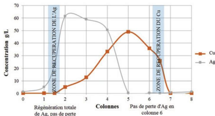
Figure 8 - Séparation du cuivre et de l'argent par SSMB à huit colonnes à partir d'une solution à 60 g/L de Ag et 40 g/L de Cu, HNO<sub>3</sub> 4N.
