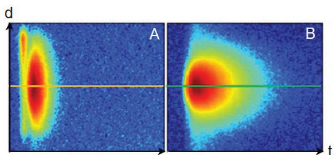
Figure 3 - Caractérisation photoniques : traces spatio-temporelles de diffusion des photons à travers A) un monolithe TiO<sub>2</sub>@Si(HIPE) et B) un lit de poudre de TiO<sub>2</sub> P25. Figure adaptée de [11].
