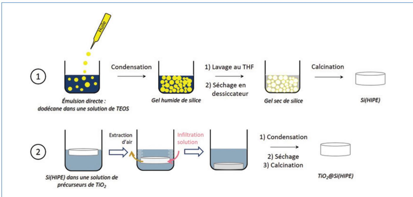
Figure 1 - Étapes successives de synthèse : 1) schéma de la synthèse des monolithes de silice Si(HIPE) ; 2) schéma de l'imprégnation des particules de TiO<sub>2</sub>.
