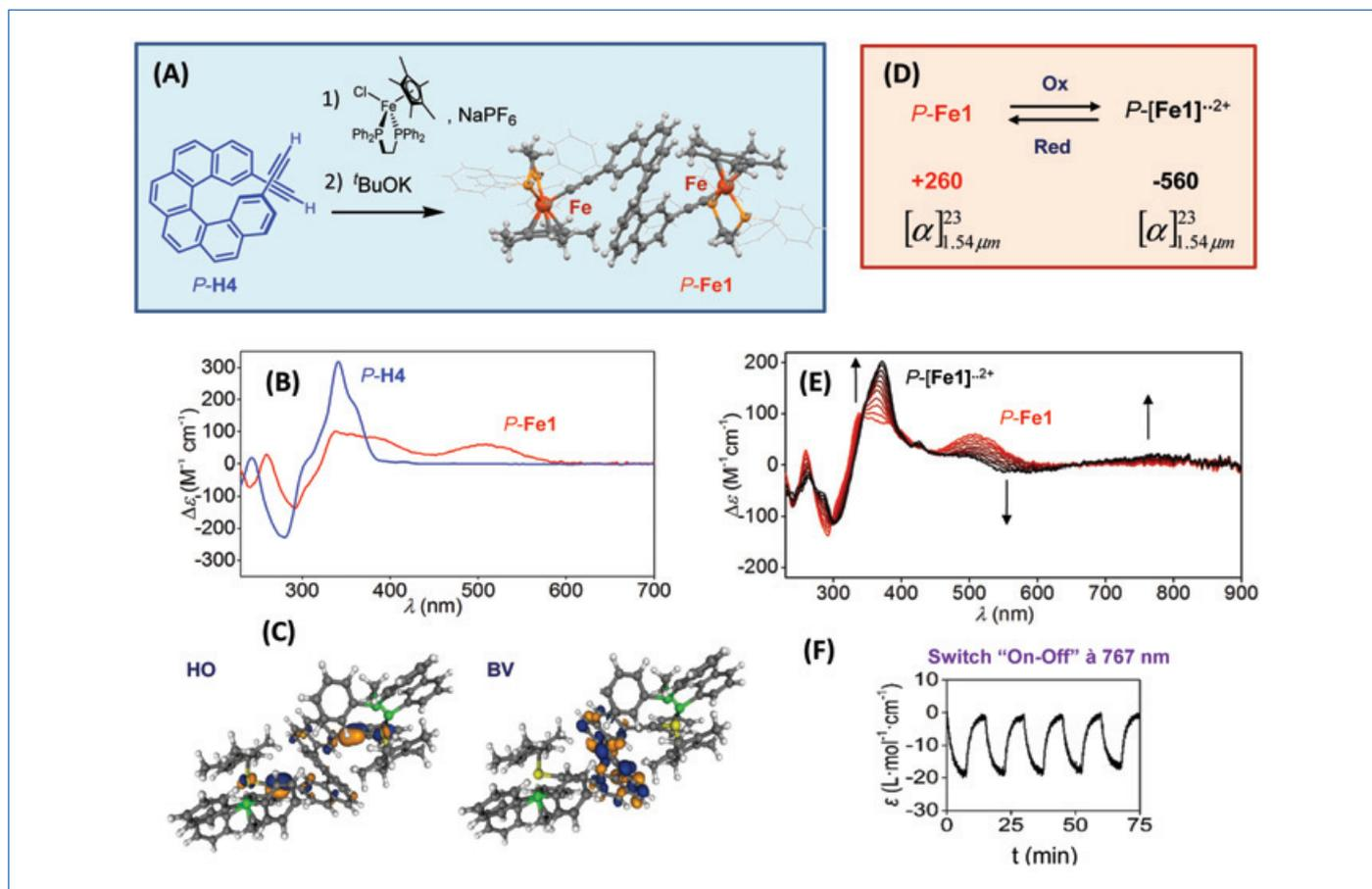
Figure 5 - (A) Préparation et structure radiocristallographique du complexe de fer-alcynyle *P-Fe1*; (B) comparaison des réponses en ECD de *P-H4* et *P-Fe1*; (C) HO et BV de *Fe1*; (D) processus redox réversible  $P\text{-Fe1} \leftrightarrow P\text{-[Fe1]}^{2+}$ ; (E) variation de la réponse en ECD de *P-Fe1* en  $P\text{-[Fe1]}^{2+}$ ; (F) commutateur optique à 767 nm montrant la réversibilité et fatigabilité du processus observées par réponse UV-visible.
