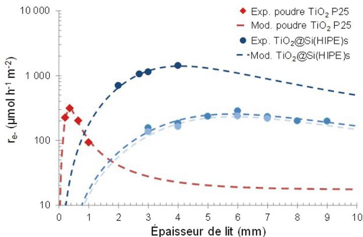
Figure 6 - Confrontation des vitesses de réaction expérimentales  $r_e$  avec le modèle en fonction de l'épaisseur du lit photocatalytique. Figure adaptée de [11].
