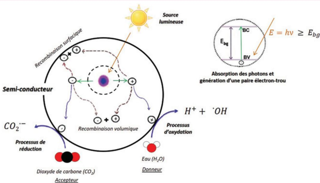
Schéma du processus photocatalytique de conversion du CO<sub>2</sub> (adapté de [2]).
