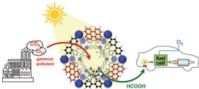
Le dioxyde de carbone réduit en acide formique, puis utilisé pour propulser une voiture grâce à une pile à combustible, en présence de dioxygène. © J. Canivet.
