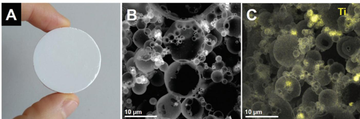
Figure 2 - Caractérisations multi-échelles des monolithes TiO<sub>2</sub>@Si(HIPE) : A) photographie ; B) diché MEB ; C) cartographie MEB-EDS, avec l'élément titane surligné en jaune. Figure adaptée de [11].
