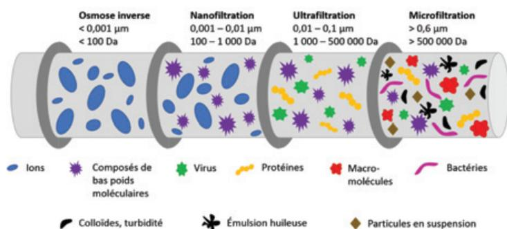
Figure 4 - Spectre d'application des filtrations proposées par Seprosys.
