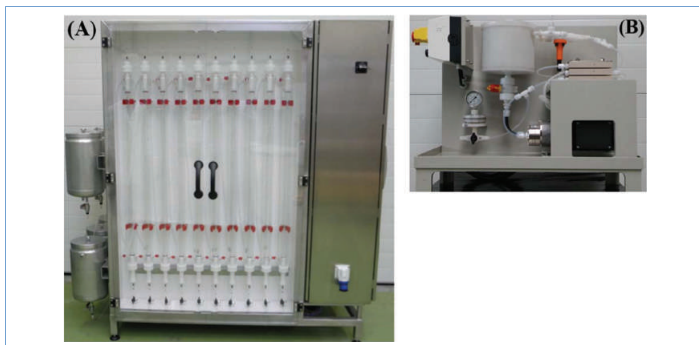
Figure 5 - Exemples de pilotes conçus par Seprosys : pilote SSMB (« sequential simulated moving bed ») dix colonnes (A) et pilote de filtration membranaire (B).
