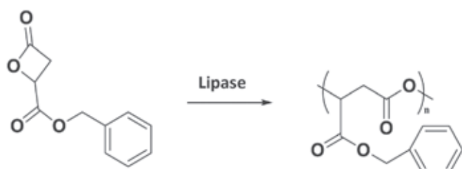
Figure 8 - Polymérisation par ouverture du cycle du MLABe.
