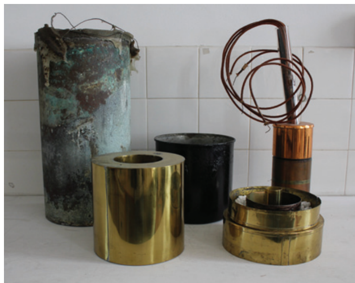
Figure 8 - Différents éléments du microcalorimètre développé par Albert Tian. À gauche, la grande cuve qui prend place dans les fosses (C sur le plan de Tian) des salles de mesure et différentes pièces constitutives du microcalorimètre (© B. Vila).
