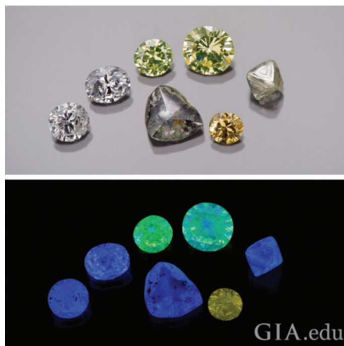
Figure 1 - Quelques diamants photographiés en lumière blanche (en haut) et sous une lampe UV (en bas) qui révèle une fluorescence bleue (le plus souvent), verte, jaune... Photos reproduites avec la permission du GIA, © Kevin Schumacher/GIA.
