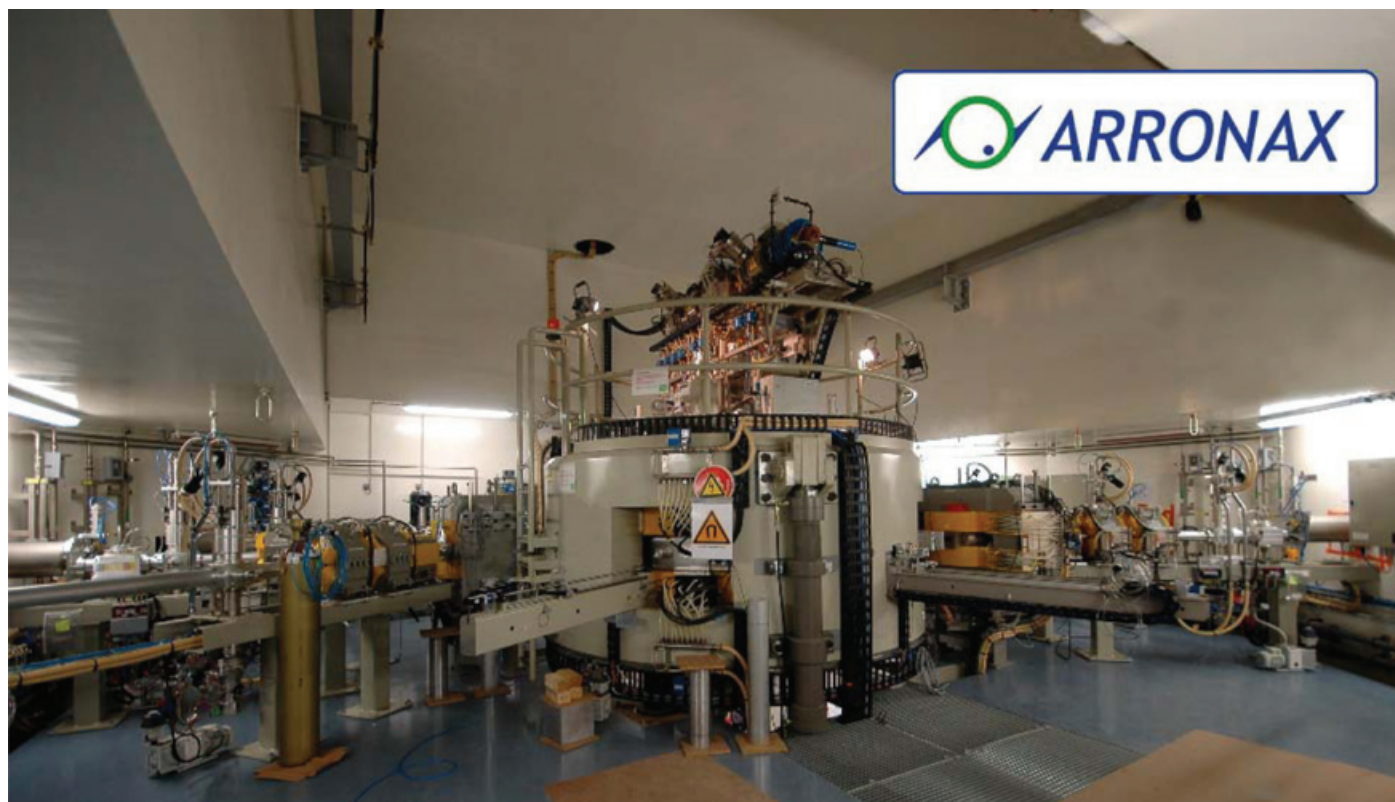
Figure 4 - Vue du cyclotron ARRONAX dans sa casemate. L'accélérateur mesure 4 m de haut et 4 m de diamètre. Les murs de la casemate sont épais de 3,7 m afin de protéger les personnels des radiations produites lors de son fonctionnement.
