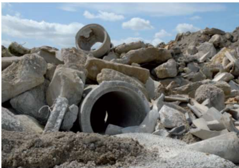
Stock de bétons de démolition avant traitement.
