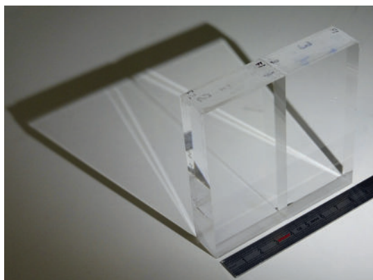
Assemblage réalisé par Cristal Laser à partir des colles sol-gel développées par le Laboratoire de chimie de l'ENS de Lyon. © Frédéric Chapat.
