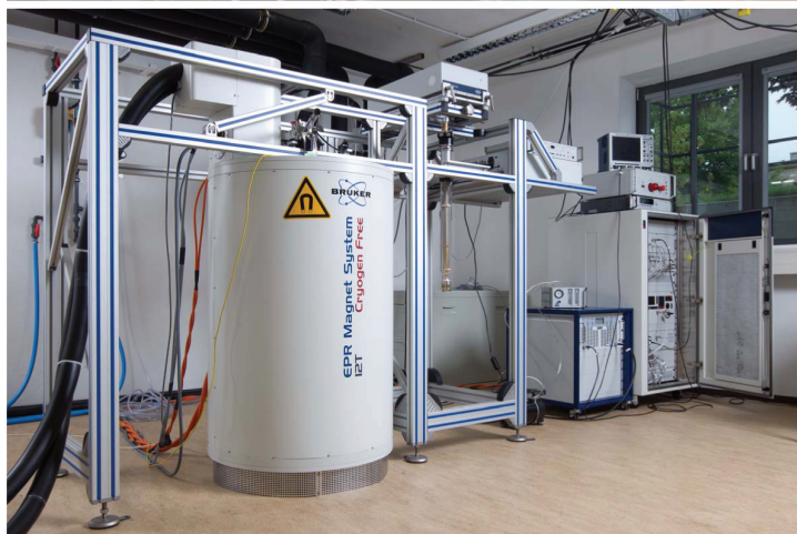
Spectromètre RPE développé par Zavoisky à 133 MHz (haut) et spectromètre 263 GHz Bruker (bas).
