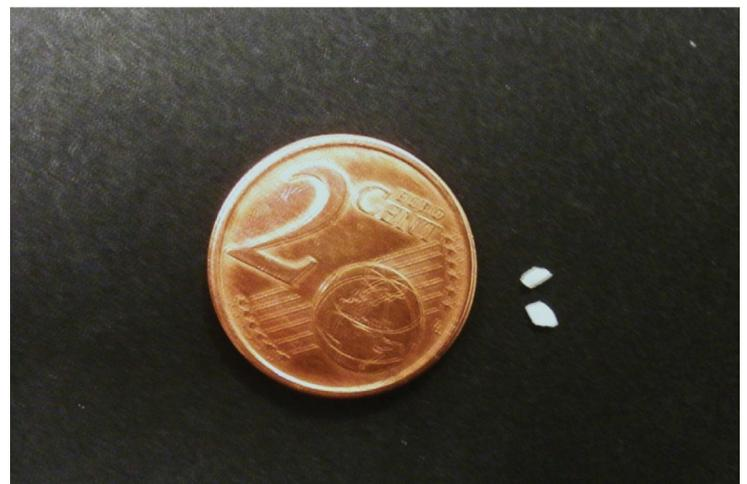
Figure 4 - Comparaison de deux fragments d'émail dentaire de masse totale de 5 mg avec une pièce de deux centimes. © IRSN.
