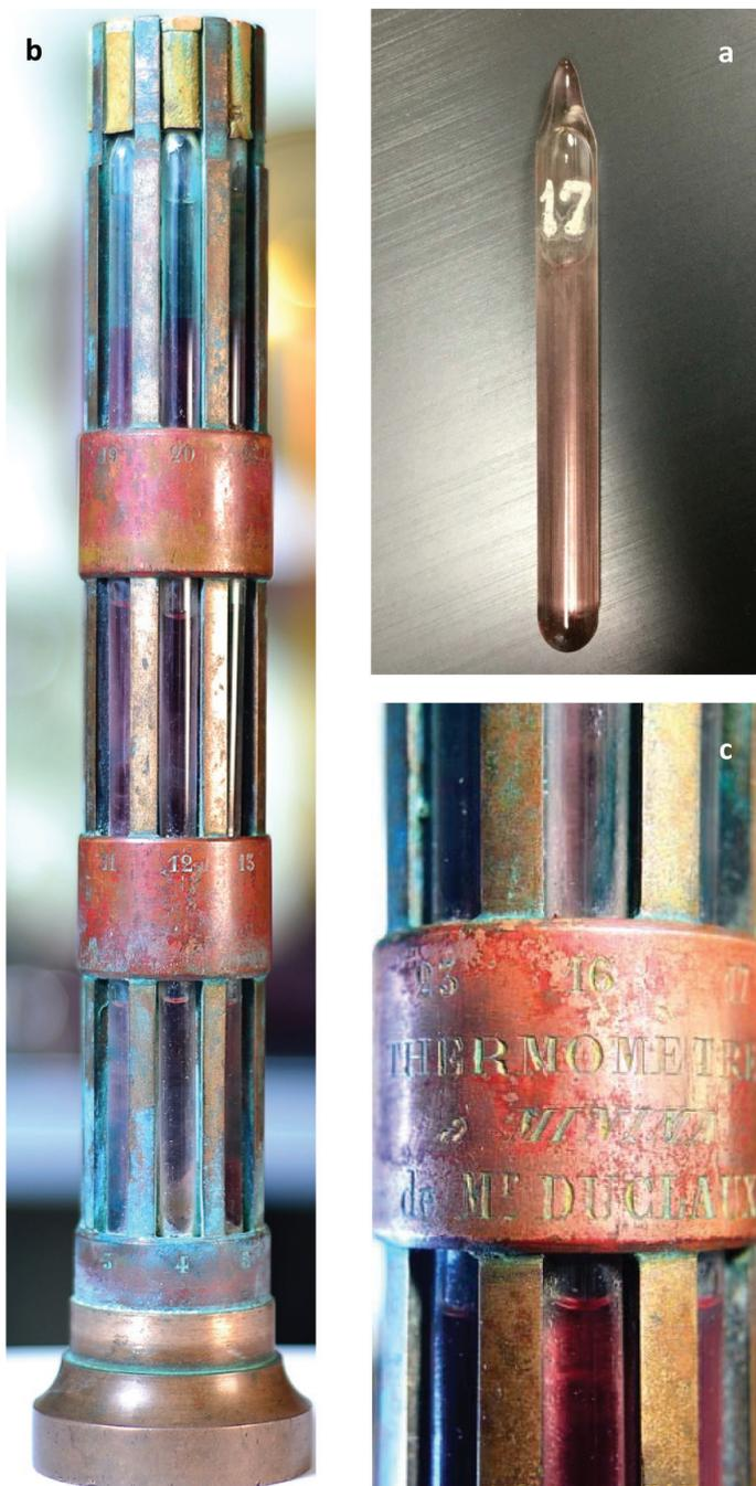
Figure 3 - a) Un des tubes scellés supplémentaires présent dans la boîte en bois. b) Le thermomètre, sans le cylindre en laiton de protection, montrant l'empilement des tubes scellés le long du corps cylindrique en cuivre. c) La plaque avec la mention « THERMOMETRE à MINIMA de M<sup>r</sup> DUCLAUX ». © Vincent Noclin/Université de Lyon.
