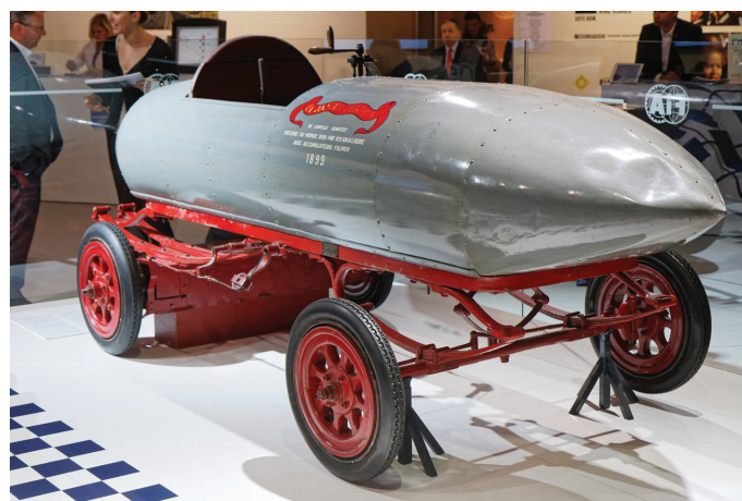
En 1899, la Jamais-Contente , voiture électrique, fut le premier véhicule à franchir 100 km/h (photo : reproduction présentée au Mondial de l'Automobile de Paris 2014, CC BY-SA 3.0).
