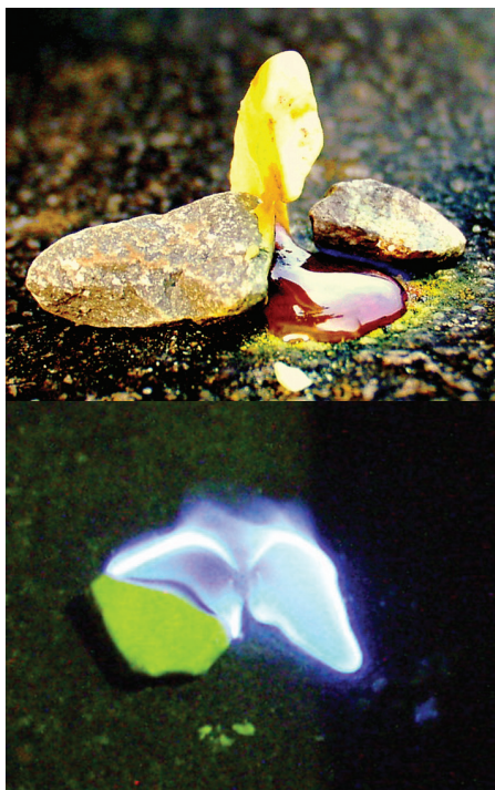
Figure 2 - La combustion du soufre produit une flamme bleue, plus facilement observable dans la pénombre (en dessous). Photos : Johannes « volty » Hemmerlein, CC BY-SA 3.0.
