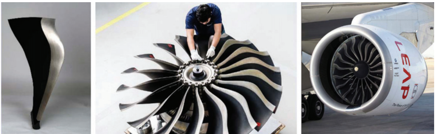
Figure 5 - Aube fan du moteur LEAP A1 (CFM International) réalisée par tissage 3D de fibres de carbone puis injection de résine époxyde en technologie RTM (« resin transfer molding »). Photos Safran, DR.
