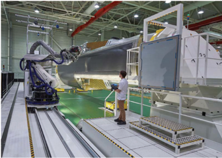
Figure 4 - Production d'un panneau de fuselage de l'Airbus A350 XWB par dépose automatisée de nappe pré-impregnée unidirectionnelle carbone/époxyde dans l'usine Airbus-Nantes à l'aide du robot C2 de la société Coriolis-composites (56-Queven). Photo Coriolis-Composites, DR.
