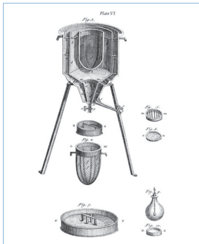
Figure 1 - Coupe transversale de la machine à glace décrite dans le Mémoire sur la chaleur de Lavoisier et Laplace en 1784; appareil renommé calorimètre dans sa description figurant dans le Traité élémentaire de chimie de 1789.
