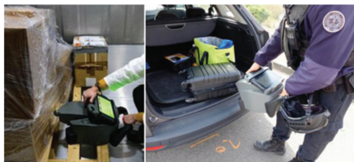
Figure 1 - Contrôles d'un colis et d'une valise avec l'appareil de détection de vapeurs d'explosifs portable T-REX.
