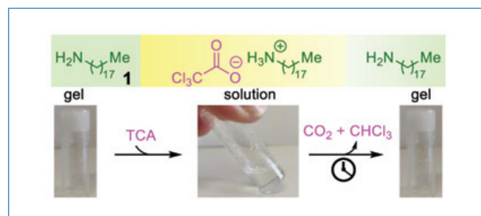
Figure 5 - Système gel-sol-gel à l'octadécylamine alimenté au TCA. L'acide carboxylique protone l'amine et la décarboxylation du TCA libérant du \text{CO}_2 et du chloroforme permet de revenir à l'état initial.
