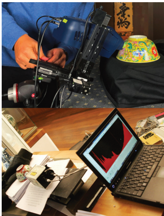
Figure 5 - Mesure sur site, non invasive et sans contact de bols impériaux (dynastie Qing) : (haut) analyse par fluorescence des rayons X d'un bol du règne de Daoguang (XIX e siècle) (Fondation Baur, Genève) ; (bas) analyse par microspectroscopie Raman d'un bol du règne de Yongzheng (XVIII e siècle) (Musée national des arts asiatiques - Guimet).
