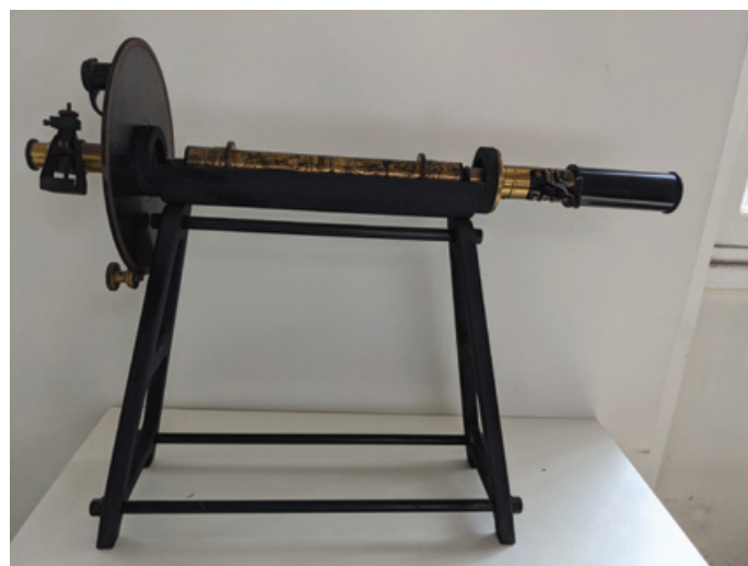
Figure 5 - Un polarimètre à prisme pour l'étude des liquides. L'observateur regarde, dans l'oculaire à gauche de l'appareil, la lumière qui est polarisée par l'objectif à droite. Le cylindre central (placé dans un berceau) contient la solution à analyser. On tourne un filtre polarisant solide du disque (gradué) jusqu'à ce que plus aucune lumière n'arrive à l'œil (© H. This).
