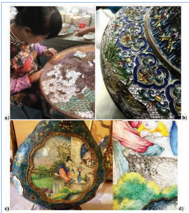
Figure 4 - Réalisation d'un décor d'émaux cloisonnés : a) la poudre de verre coloré remplit le volume entre les cloisons collées/soudées sur le support ; b) après une première cuisson, le verre ayant réduit de volume, un nouveau remplissage est effectué ; ces opérations sont faites plusieurs fois ; on note que la couleur avant cuisson est différente de celle de l'émail final ; c) aiguière en or offerte par Napoléon III à son épouse l'Impératrice Eugénie associant un décor en émaux cloisonnés et en émaux peints (diamètre ~ 20 cm) (Musée chinois, Château de Fontainebleau) [12] ; d) noter la technique de peinture par points de couleurs : l'analyse Raman montre que dans un point, à l'échelle micronique, la teinte est obtenue par l'association de plusieurs pigments.
