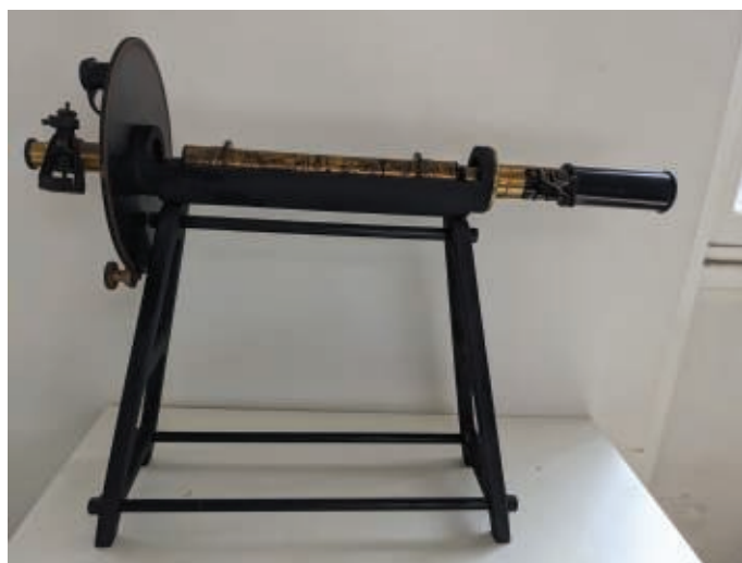
Figure 5 - Un polarimètre à prisme pour l'étude des liquides. L'observateur regarde, dans l'oculaire à gauche de l'appareil, la lumière qui est polarisée par l'objectif à droite. Le cylindre central (placé dans un berceau) contient la solution à analyser. On tourne un filtre polarisant solide du disque (gradués) jusqu'à ce que plus aucune lumière n'arrive à l'œil (© H. This).
