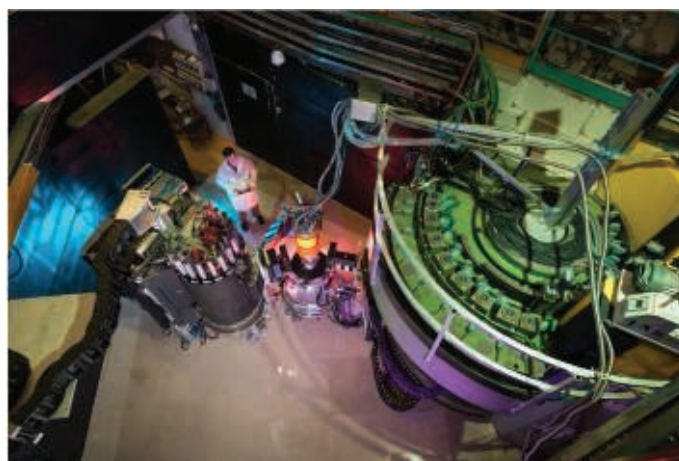
Figure 3 - Un spectromètre de neutrons du type trois axes (IN8 à ILL) pour l'étude du magnétisme, des vibrations du réseau dans les solides et des excitations dans les liquides. © L. Thion.
