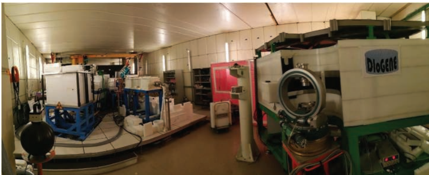
Figure 3 - Au CEA Saclay : la casemate de l'accélérateur IPhi sur lequel les tests de la cible de béryllium, du modérateur (à gauche) et de l'appareil de diffusion Diogene sont effectués.
