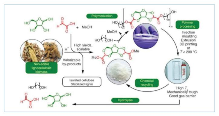
Produit à partir de biomasse végétale non comestible, le bioplastique affiche les mêmes propriétés que le PET. Il peut en outre être facilement recyclé ou se dégrade sous forme de sucres par simple hydrolyse. © L. Manker *et al.* [7].
