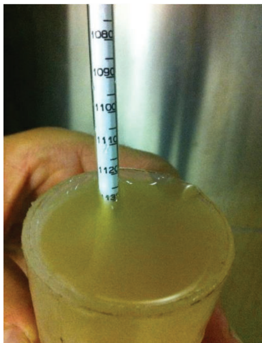
Figure 11 - Au fil des années et sous l'effet de l'évolution du climat, le multimètre ne cesse de monter ! La concentration en sucre des jus étant sans cesse plus élevée, la densité des moûts l'est aussi, entraînant une poussée d'Archimède sur cet outil ancien mais toujours utilisé (ici un degré fort).
