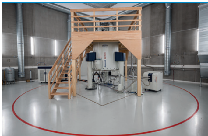
Le nouveau spectromètre RMN 1 200 MHz installé à Lille. © Alexandre CAFFIAUX - Université de Lille.
