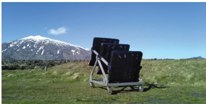
Figure 2 - Vue d'un détecteur à muons face au dôme d'un volcan islandais, le Snæfellsjökull. Les trois plans de détection ont une surface d'un mètre carré ; le détecteur pointe vers le sommet du volcan, situé à plusieurs kilomètres. © Carol Müller.
