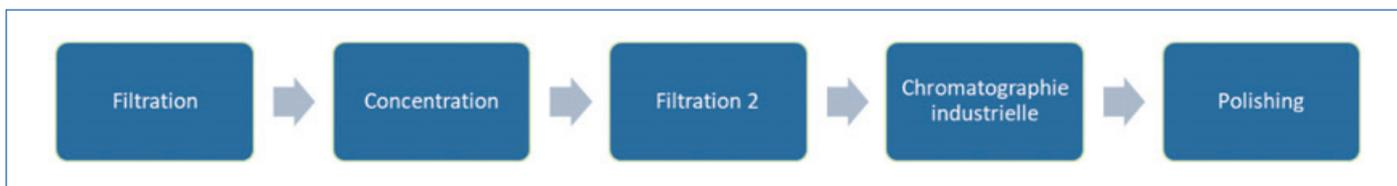
Figure 4 - Exemple de chaînage de purification d'un hydrolysat secondaire menant à obtenir un sirop de sucres purifié mis au point lors du projet BIO3.
