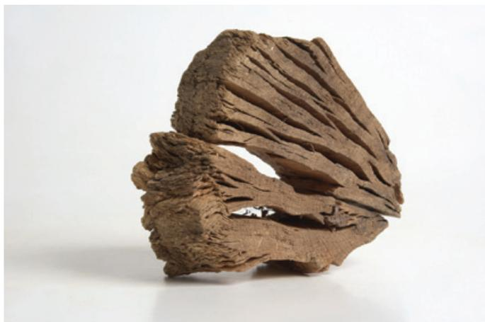
Figure 2 - Exemple d'un fragment de bois archéologique ayant subi un séchage à l'air montrant des déformations et une fissuration importantes induites par effondrement cellulaire.
