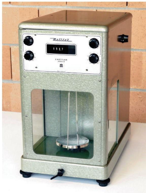
Figure 6 - Balance Mettler B5, dans son boîtier métallique vitré. 4 boutons rotatifs actionnent le jeu de poids interne : 0-100 g, puis 3 décades 0-90 g, 0-10 g et 0-1 g. Lecture optique des décimales suivantes. Collection UNIL/EPFL, Inv. 603.0740.
