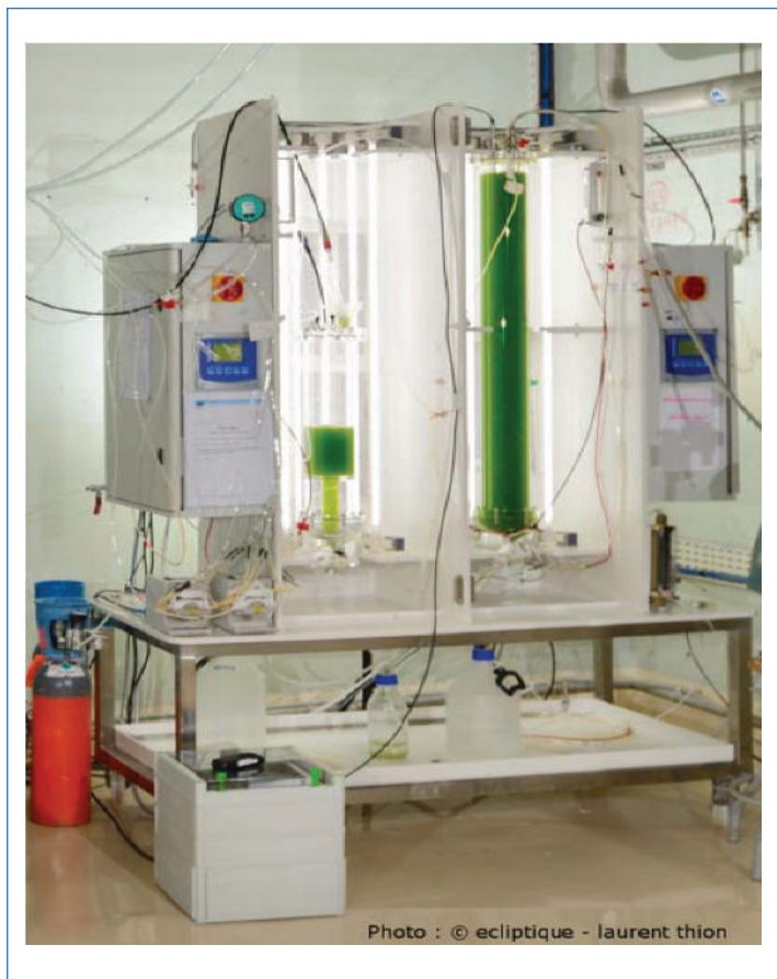
Figure 3 - Pilote de procédé de décontamination d'effluents radioactifs par microalgues. © ecliptique/Laurent Thion.
