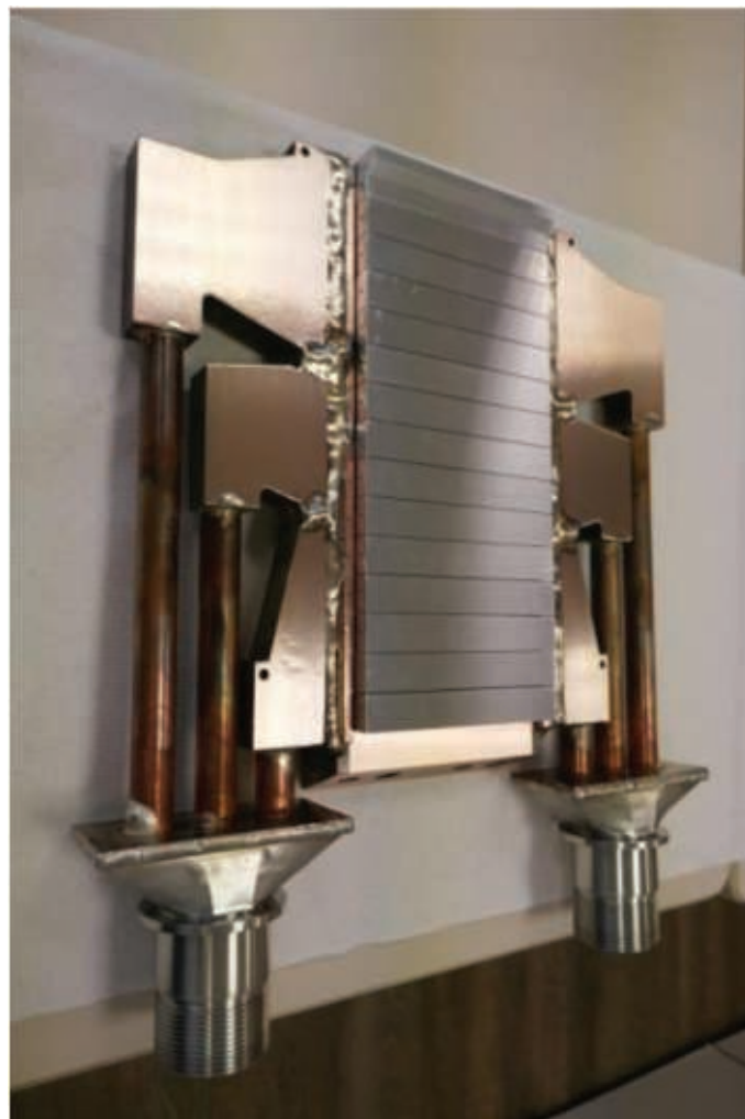
Figure 1 - Cible de béryllium sur son support en cuivre. L'ensemble est refroidi par un circuit d'eau sous pression. En fonctionnement, la face avant du béryllium soumise au bombardement des protons est à une température de l'ordre de 600 °C.
