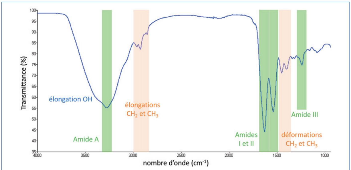
Figure 4 - Spectre IR de la membrane coquillère.
