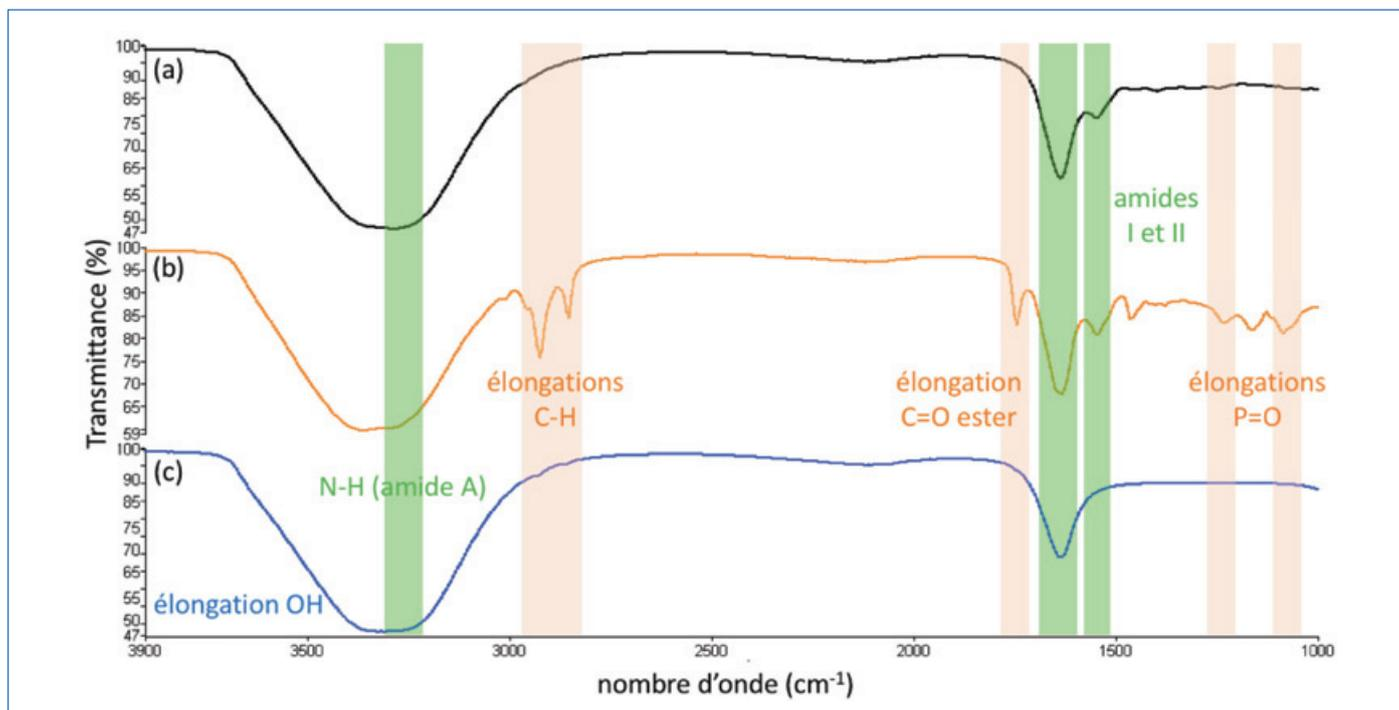
Figure 6 - Comparaison des spectres IR de l'albumen (a), du jaune d'œuf (b) et de l'eau (c) avec mention des bandes IR d'intérêt. Spectres séparés pour faciliter la comparaison.
