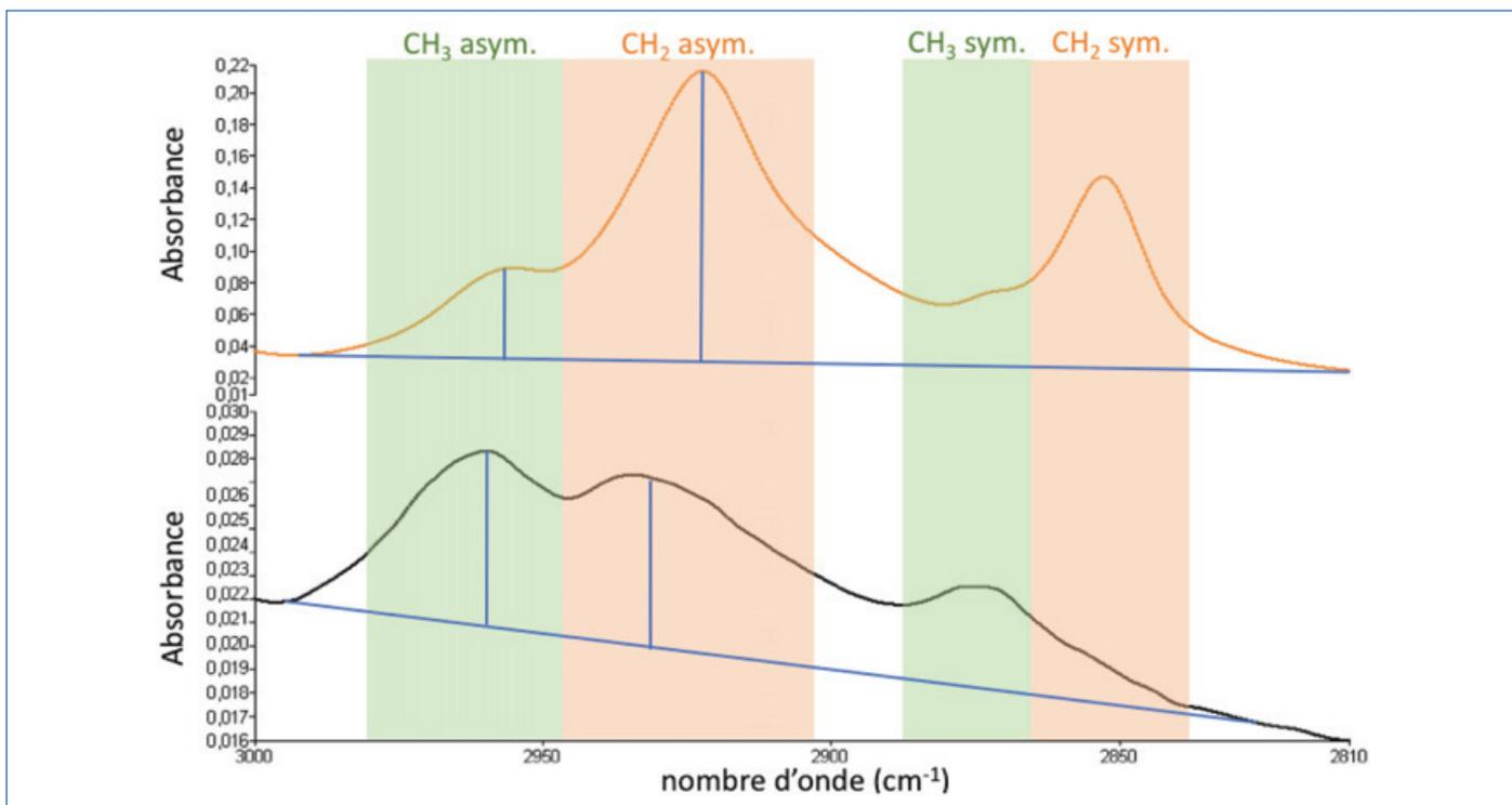
Figure 10 - Mesure des hauteurs en absorbance des bandes CH<sub>2</sub> et CH<sub>3</sub> asymétriques, pour du jaune séché (orange) et du blanc séché (noir).
