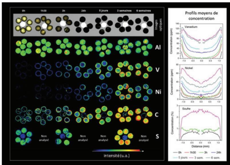
Figure 3 - Imagerie et profils LIBS de la diffusion d'impuretés dans des supports de catalyseurs d'hydrotraitement [10].
