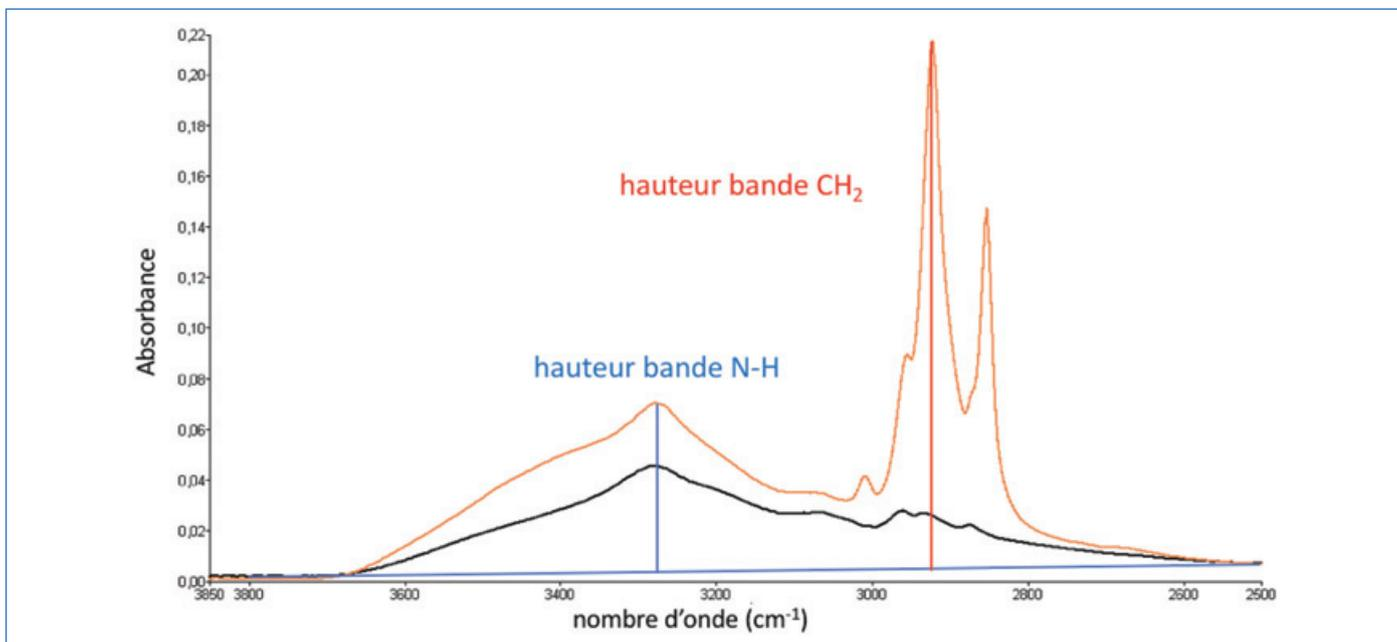
Figure 11 - Mesure des hauteurs en absorbance des bandes N-H et CH<sub>2</sub>, pour du jaune séché (orange) et du blanc séché (noir).
