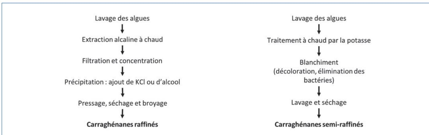
Figure 4 - Schéma des procédés d'extraction des carraghénanes raffinés et semi-raffinés.
