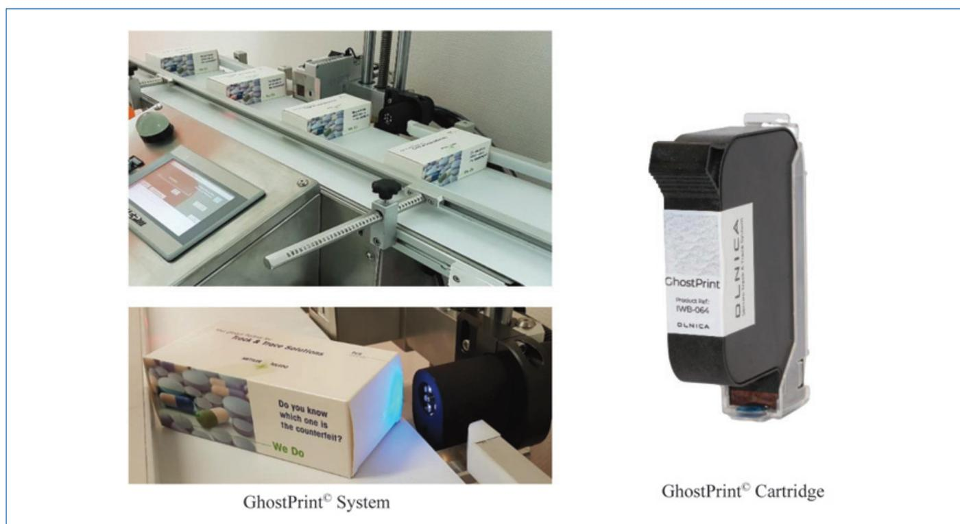
Figure 2 - GhostPrint Marking : le système de marquage invisible des packagings.
