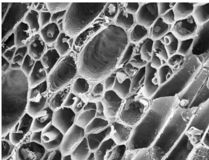
Figure 1 - Vue en microscopie électronique à balayage (MEB) d'une microstructure de bois archéologique dégradé montrant des parois cellulaires très fines.
